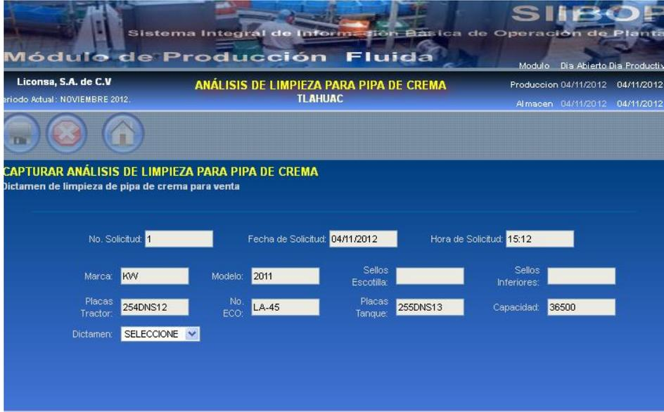
El siguiente paso es dictaminar, para esto de la lista **Dictamen: SELECCIONE** se elige el resultado de la inspección de la pipa, si la pipa esta correctamente lavada se selecciona liberada pero si la pipa esta sucia se elige rechazada.
